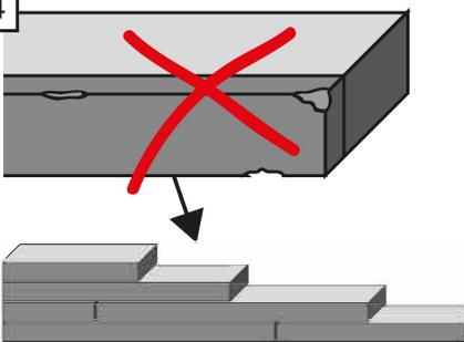
Geen defecte stenen verwerken (zichtzijde).
